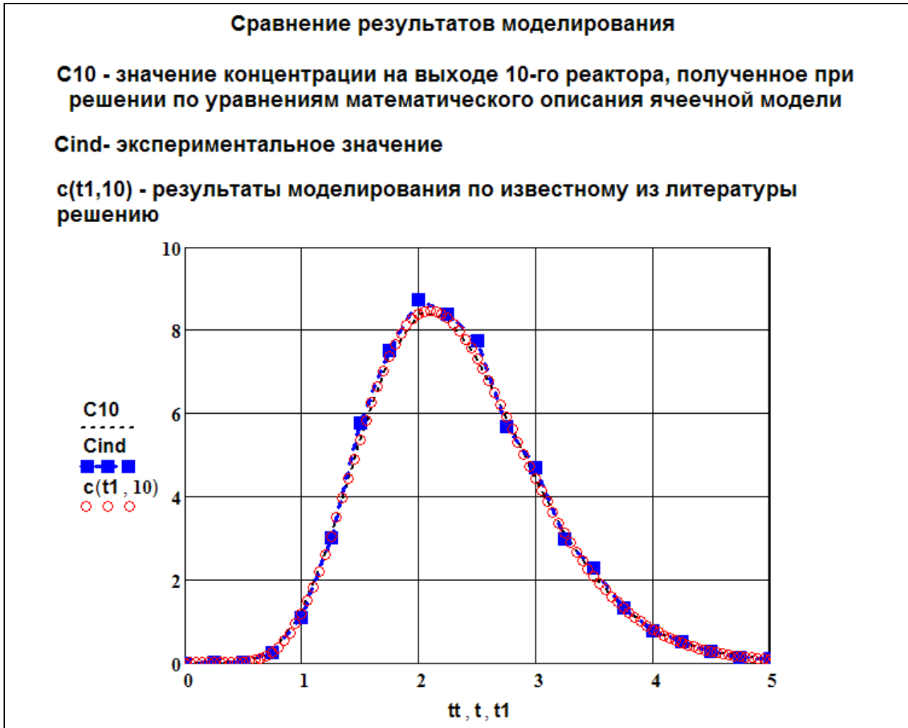
Рисунок 15 – Сравнение в Mathcad расчетных и экспериментальных данных (квадратные точки с пунктирной линией)
